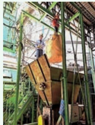
破碎チップ、ペレットのマテリアル投入設備
