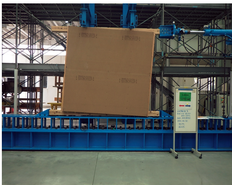
面内せん断試験の様子
