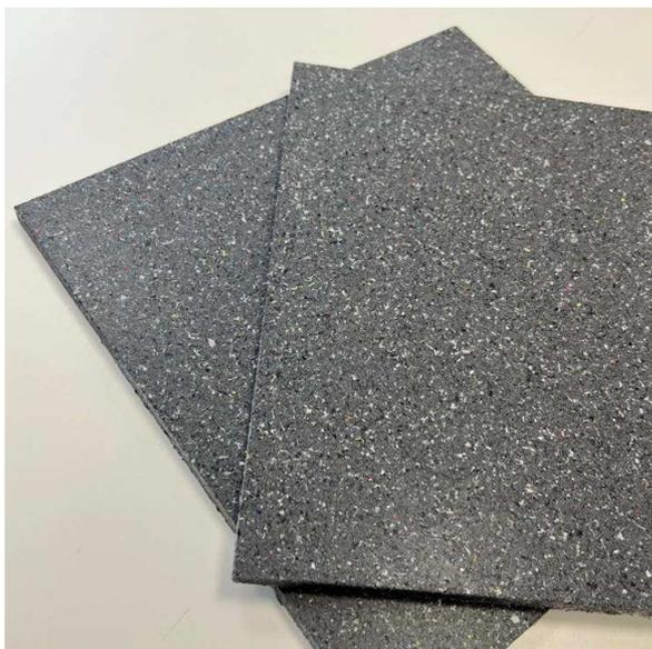
※量産試験によって製造された「PANECO® board V」
